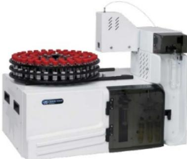
使用注意事项：吹扫气流与吹扫时间吹扫气流速取决于样品中待测物的浓度、挥发性、与样品基质的相互作用（如溶解度）以及其在捕集管中的吸附作用大小。用氦气，流速范围为20-60ml/min；用氮气时可稍高一些，但氮气的吹扫效果不及氦气。原因是氮气在水中的溶解度比氦气大。注意，吹扫流速太大时会影响样品的捕集，造成样品组分的损失。解吸时的载气流速主要取决于所用色谱柱。用填充柱时为30-40ml/min；用大口径柱时为5-10ml/min；用常规毛细管柱时则要按分流或不分流模式来设置载气流速。吹扫时间是吹扫-捕集技术的重要参数之一，须根据具体样品来优化确定。原则上，吹扫时间越长，分析重现性和灵敏度越高。但考虑到分析时间和工作效率，应在满足分析要求前提下，选择尽可能短的吹扫时间。实际工作中可通过测定标准样品的回收率来确定吹扫时间。捕集装置，就选上海禹重实业有限公司，有想法的可以来电咨询！
